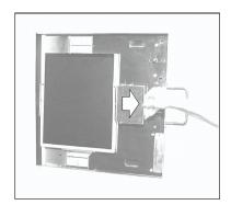
5. WHILE PUSHING CLAMP AGAINST CASSETTE PRESS CLAMP HANDLE DOWN.
