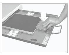
5. WHILE PUSHING CLAMP AGAINST CASSETTE PRESS CLAMP HANDLE DOWN.
