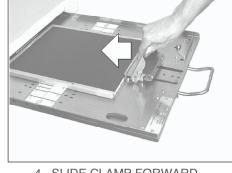
4. SLIDE CLAMP FORWARD PUSHING CLAMP FIRMLY AGAINST CASSETTE.
